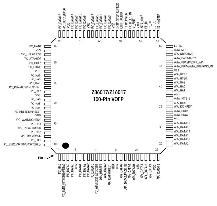
Figure 1-8. 017 100-Pin VQFP Pin Configuration
